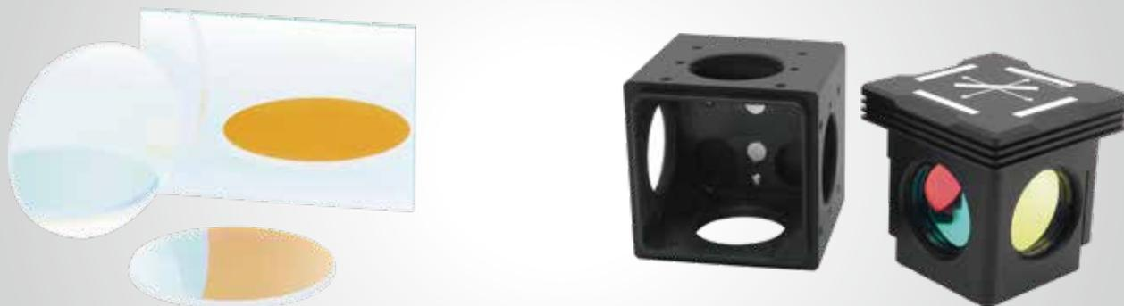
荧光滤光片 (Fluorescence Filters) 指的是应用于荧光系统的各种滤光片, 包括提取荧光能量或获得荧光成像。它的主要特点是对干扰光的隔离度好, 自发荧光干扰少。像PCR仪、荧光免疫分析仪、荧光显微镜等各种医疗分析和检测仪器中都会用到荧光滤光片。通常要求荧光滤光片的截止深度在OD5(optical density, 光密度,  $OD = -\lg T$ ) 以上。
