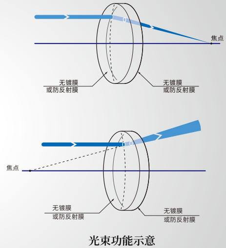
球面透镜系列包括平凸透镜、平凹透镜、双凸透镜、双凹透镜4种球面透镜类型可选；
