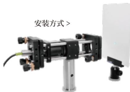
CWP-C 圆楔形棱镜组合是一个精密手动光束转向装置，非常适合激光束操控应用，可使正入射棱镜垂直表面的光束偏转。该楔形棱镜安装座包含的一对圆楔形棱镜，兼具 $360^\circ$ 的连续粗调范围，可用于安装座前后部的滚花圆环手动粗调。调整校对光束完成后，通过上下两端的紧定螺丝锁定。
