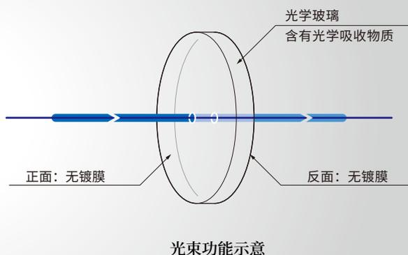
滤光片种类繁多,其特性也被划分得很细。熟练利用这些特性,可以提高光学实验的精度。滤光片的构造简单,交换方便,准备几个滤光片,通过更换滤光片可以创造出最佳光学条件。
