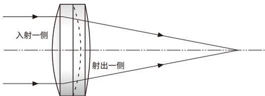
入射消色差透镜的平行光有方向性,为了得到性能较佳,要从曲率半径较小的一侧射入平行光,曲率半径大的一面(平坦的面)应该背离准直光束。
