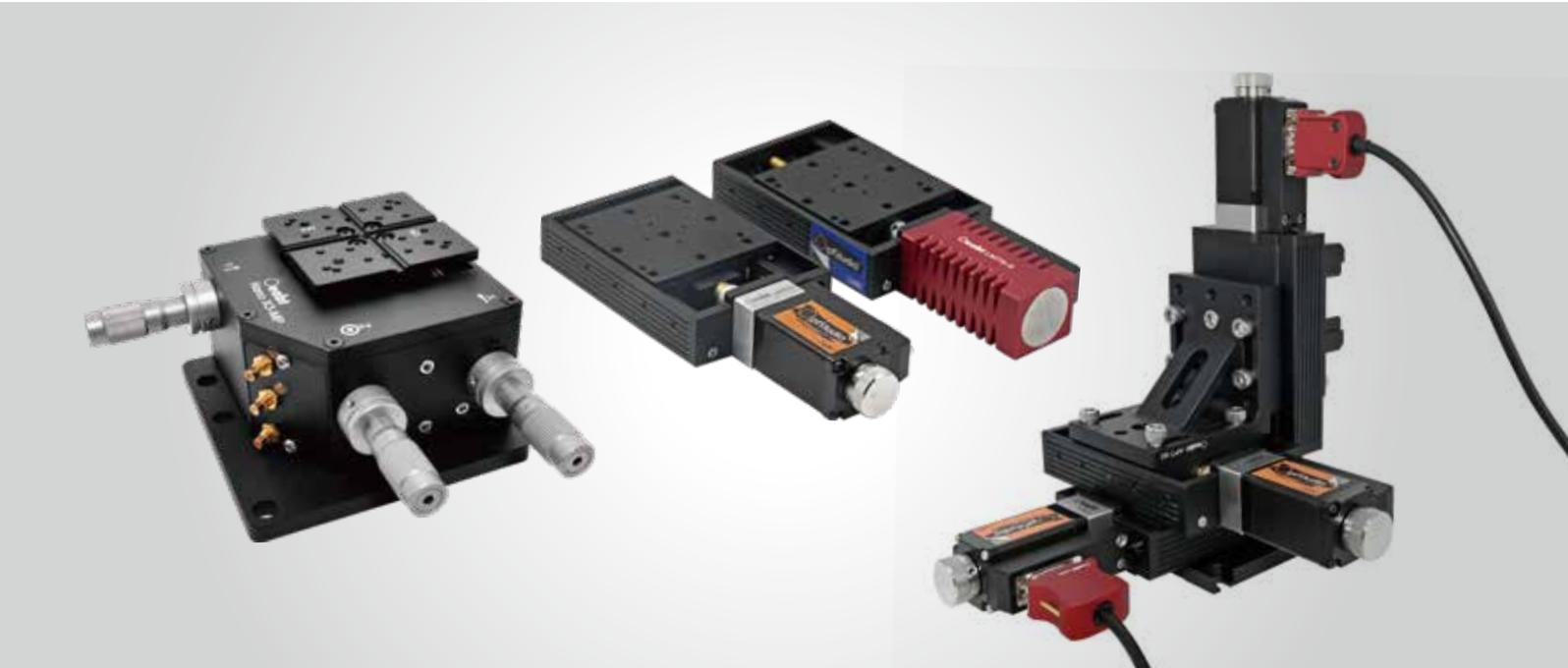
Oeabt的三轴Nano X3系列挠性位移台集成了开环压电驱动器,压电驱动器能够使位移台达到纳米分辨率。游标测微头调节器的Nano X3位移台提供4mm行程。压电驱动器提供20μm行程,可以使用我们开环压电控制器控制。平行挠性设计确保了精确、平滑、连续的运动,摩擦可以忽略。最大负载1 kg。
